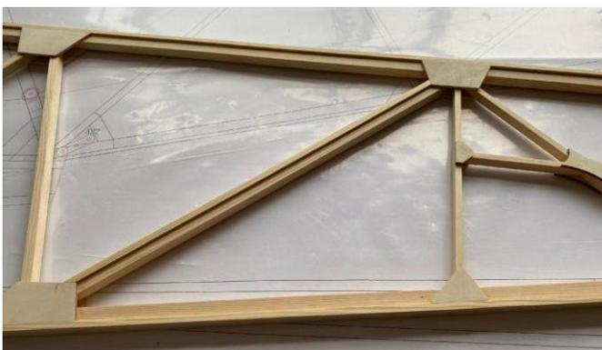
**8) Assemble fuselage lateral plates.**
