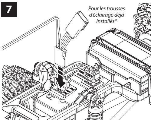
Branchez le faisceau en Y dans un port ACC ouvert sur le module de commande électronique (ECM). Les feux à DEL s'allument lorsque l'ECM est mis sous tension une fois la batterie branchée.
