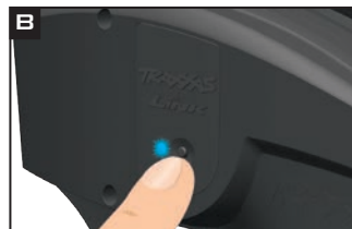
Tapez et glissez pour ajuster la TSM, la sensibilité de la direction, le réglage de l'accélération, le pourcentage du freinage, etc. !
