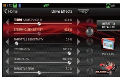
Tapez et glissez pour ajuster la TSM, la sensibilité de la direction, le réglage de l'accélération, le pourcentage du freinage, etc. !
