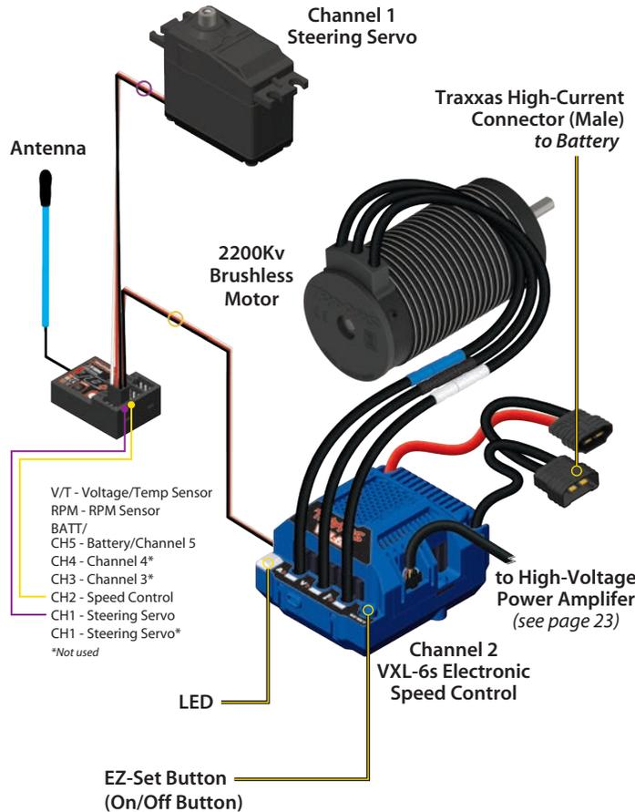
**ESC/Motor Wiring Diagram**
