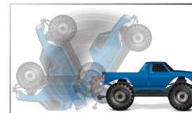
Si une personne ou un animal s'approche du modèle pendant l'auto-redressement, annulez immédiatement la manœuvre en bougeant le volant ou l'accélérateur. Appuyez et maintenez le bouton SET enfoncé sur le transmetteur pendant quatre (4) secondes afin d'activer la fonction d'auto-redressement. Une fois qu'il est activé, relâchez le bouton SET.
