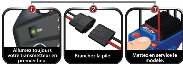
• Utilisez toujours des piles nouvelles ou récemment chargées pour le système radio. Les piles faibles limitent le signal radio entre le récepteur et le transmetteur. La perte du signal radio peut faire perdre contrôle du modèle.
