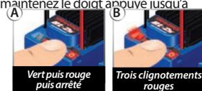
4. Le témoin DEL clignote et puis devient vert constant (le détecteur de basse tension est ACTIVÉ) ou rouge constant (le détecteur de basse tension est DÉACTIVÉ). Le modèle est prêt à conduire.
