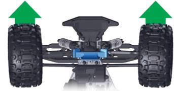
7. Actionnez doucement l'accélérateur pour vous assurer que le véhicule bouge en avant et en arrière et que le moteur s'arrête lorsque l'accélérateur est à la position neutre.
