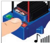
**Pour désactiver le détecteur de basse tension (configuration pour les piles NiMH) :**
