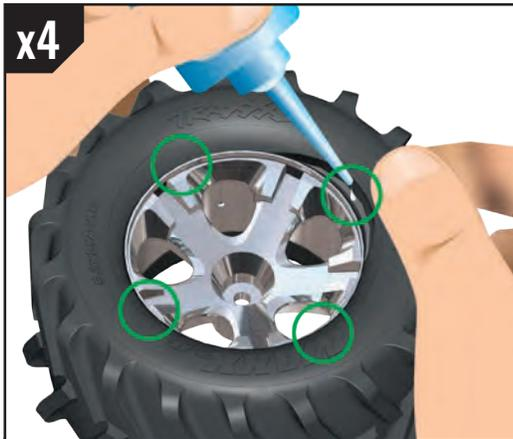
Collez les pneus aux roues. Utilisez votre pouce pour pousser le bord du pneu afin de l'écarter de la roue. Répétez l'action aux quatre points autour de la roue. Retournez la roue et répétez la procédure sur l'intérieur de la roue.
