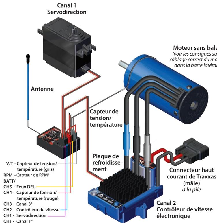
\*Non utilisé <sup>1</sup>Port de capteur accessoire à utiliser avec le capteur standard de télémétrie pour la RPM (voir plus de renseignements sur Traxxas.com et dans les matériels fournis)
