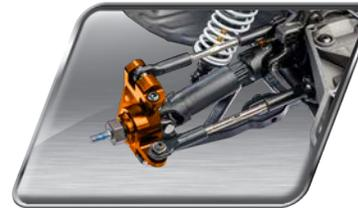
Moyeux-C et blocages de direction en aluminium
