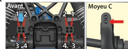
La position 4 est la position par défaut.) Pour rabaisser encore le centre de roulis, montez les embouts extérieurs des biellettes de carrossage à la position inférieure sur le moyeu C.
