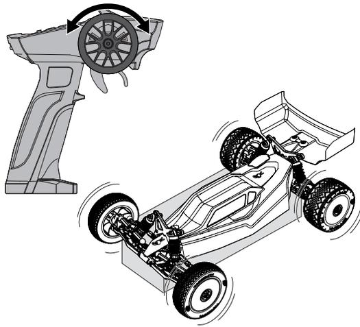
4. Commencez par rouler lentement et si le véhicule ne roule pas droit, réglez la direction à l'aide du potentiomètre du trim de direction.
