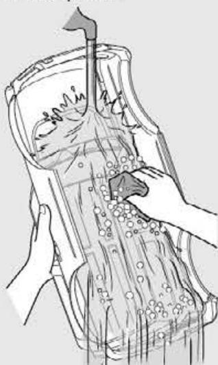
★塗装前に中性洗剤で油気をおとします。水洗いをし洗剤分を洗い流して乾かしてください。
