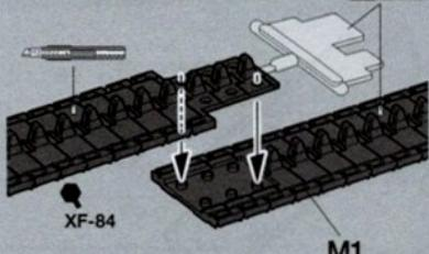
●接着剤が他の部分につかないように履帯の端を図のようにはめ込み、接着します。このとき、接合部がはがれやすいのでしっかりと接着してください。
