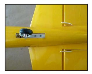
INSTALL RUDDER CONTROL HORN.
