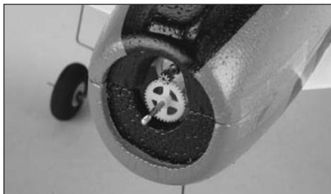
3. Faites tourner la couronne de l'arbre d'hélice dans le sens horaire pour retirer l'écrou.
