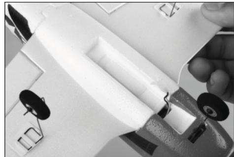
**Remarque :** vous pouvez ajuster la hauteur de la roulette de nez en tirant légèrement la jambe correspondante afin de créer un angle d'attaque plus positif et d'accroître la garde au sol de l'hélice.
