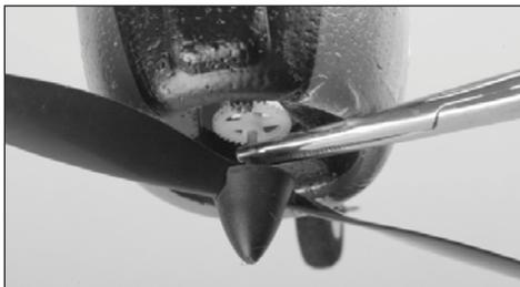
2. Retirez l'hélice en la faisant tourner dans le sens antihoraire sur l'arbre fileté.
