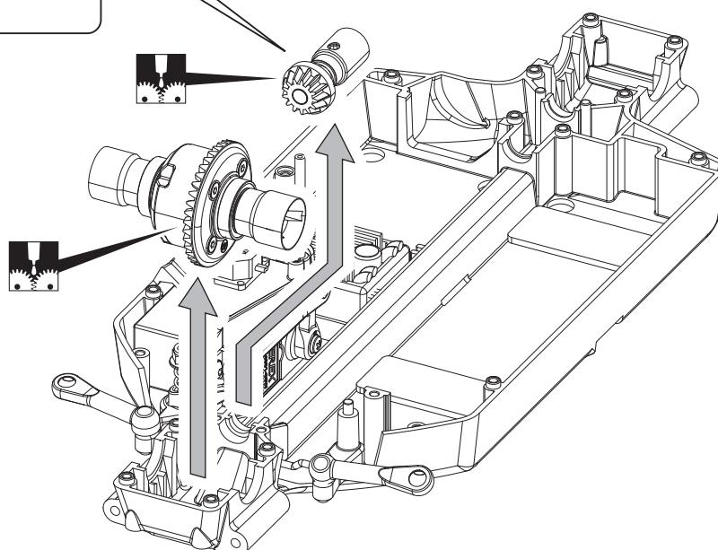
**17** デフギヤの分解 / Replacing Diff Gear / Differential austauschen
