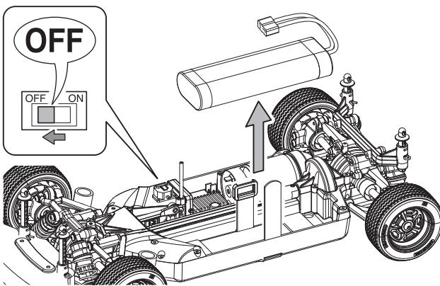
▶走行後や、走行させない時は必ず電源スイッチをOFFにし、車体と送信機の電池を取り外してください。誤作動や電池の発熱・液漏れなど危険な場合があります。
