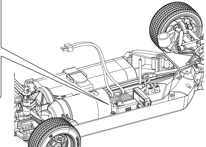
▶付属のスピードコントローラーはジャンパーピンを差し替えることで設定を変更できます。
