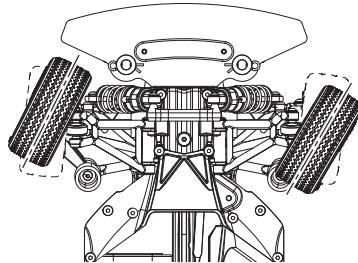
►ステアリングD/Rアジャスターを右側に一杯回した所から、1目盛分戻した所が最大舵角の目安となります。
