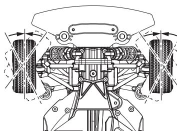
►ステアリングホイールに指を触れない(ニュートラル)ときタイヤがまっすぐになるようにステアリングトリムで微調整します。
