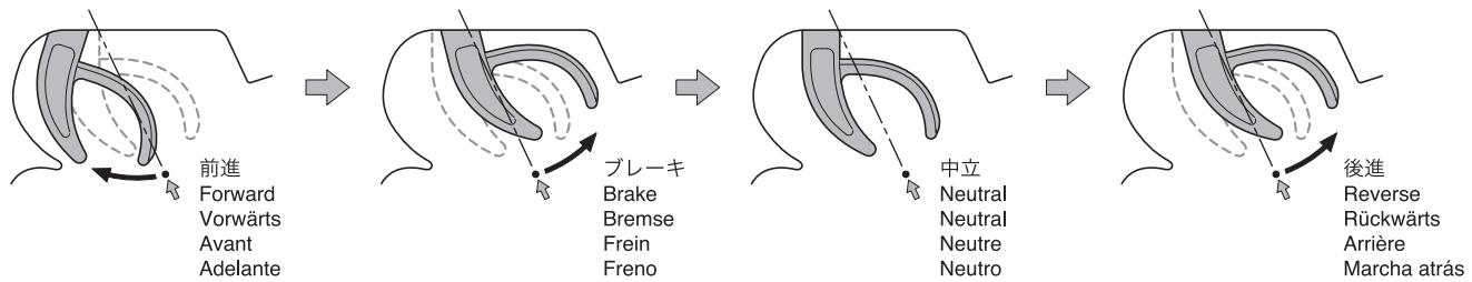
**スピードコントローラーの設定 / Speed controller setting / Einstellung des Fahrtenreglers /
