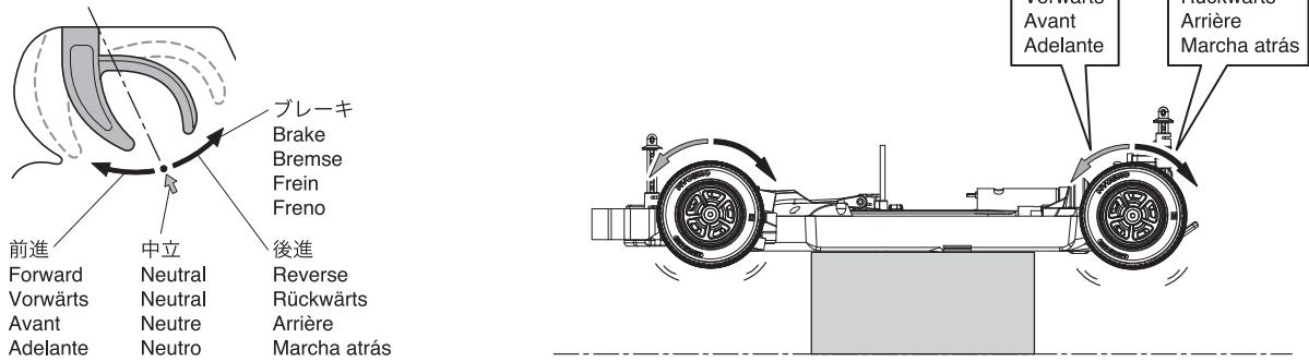
▶ 前進 - ブレーキ - 後進の操作方法 (工場出荷時の設定)
