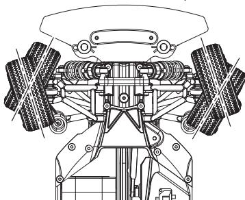
\*ステアリングホイールの操作量に応じて舵角が変わります。操作量が大きいほど、舵角も大きくなります。
