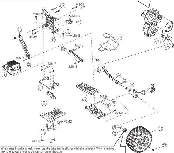
Bitte achten Sie bei der Radmontage darauf, dass die Radachse im Radmitnehmer sitzt und dass der der Querstift nicht heraus fällt.
