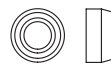
AX30113 (x4) Rubber Bump Stop 3.6x7x4mm Gummianschlag 3,6 x 7 x 4 mm Butée en caoutchouc 3,6 x 7 x 4 mm Fine corsa in gomma 3,6x7x4 mm
