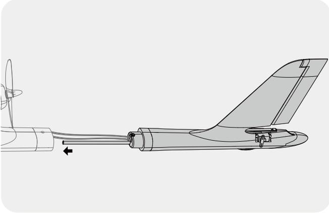
2. 如图所示，使用螺丝固定前后机身对接处。
