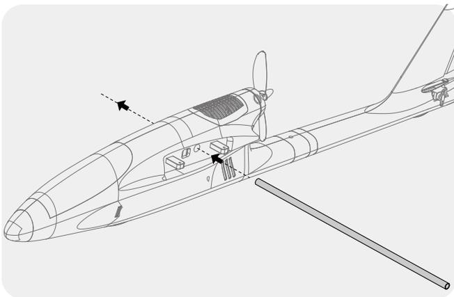
2. 将主翼安装至机身并穿舵机线到机身内，连接2Y线。
