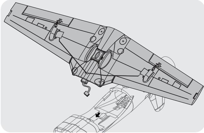
2.如图所示，使用附螺丝固定机翼至机身。注意:请勿过锁螺丝。
