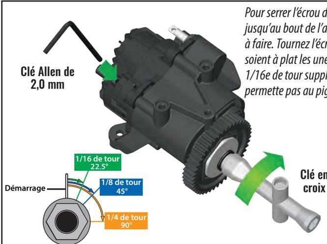
Pour serrer l'écrou de glissement, insérez la clé hexa de 2,0 mm dans le trou jusqu'au bout de l'arbre d'entrée. L'arbre est ainsi verrouillé en vue des réglages à faire. Tournez l'écrou de réglage jusqu'à ce que les quatre rondelles de ressort soient à plat les unes contre les autres, puis serrez l'écrou en lui faisant faire un 1/16e de tour supplémentaire (ou jusqu'à ce que l'embrayage à glissement ne permette pas au pignon droit de glisser pendant le fonctionnement normal).
