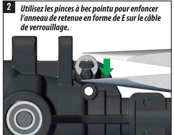
Utilisez les pinces à bec pointu pour enfoncer l'anneau de retenue en forme de E sur le câble de verrouillage.
