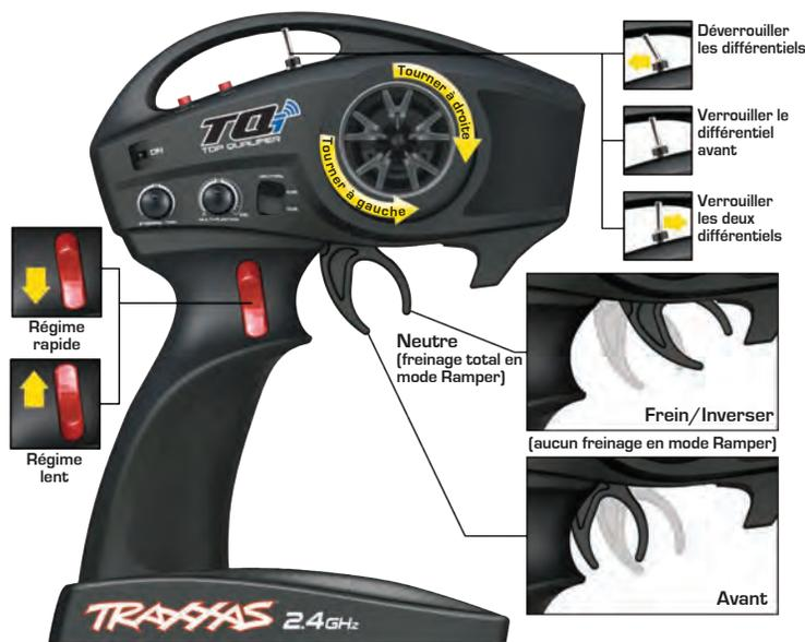
**Note :** Remettez la manette du transmetteur en position neutre et soulevez pour activer l'accélérateur en marche arrière à moins que la contrôleur de vitesse électronique soit en mode Ramper (consultez la section "Sélectionner le mode d'accélération" pour plus d'informations).
