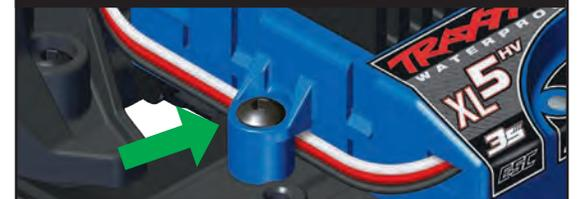
Branchez les raccords boucle du moteur dans l'ESC
