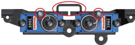
Tenez compte de l'orientation du bras du servo. Les supports de la cuvette à billes doivent se trouver du même côté que la boucle supérieure du support du servo.
