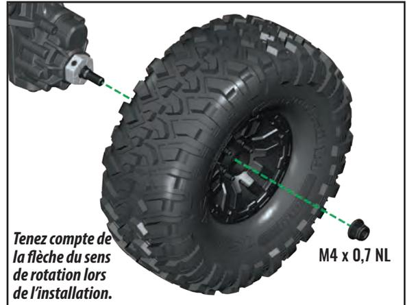
Collez les pneus aux roues. Utilisez votre pouce pour pousser le bord du pneu afin de l'écarter de la roue. Répétez l'action aux quatre points autour de la roue. Retournez la roue et répétez la procédure sur l'intérieur de la roue.
