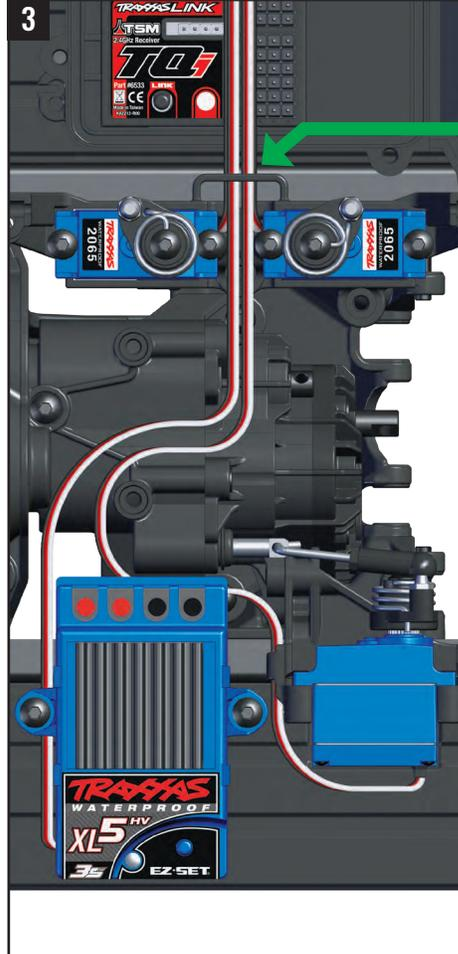
**!** Faites passer les fils de l'ESC et du servo de direction dans la boucle supérieure du support de servo T-lock avant d'installer le support sur le châssis.
