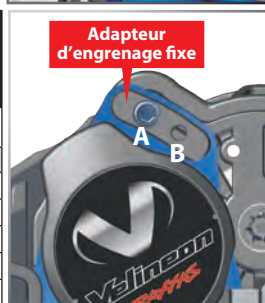
Position de la vis du moteur dans l'adaptateur d'engrenage fixe pour régler l'engrènement
