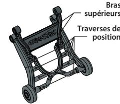
Pos. #1 : L'angle le plus élevé des roues (la position la plus basse sur les traverses). Permet au véhicule de se replier le plus pour les cabrés plus longs.
