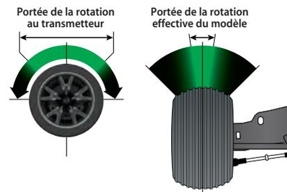
plus prononcé. La sensibilité de direction diminuée peut être utile lorsque vous conduisez le modèle sur des surfaces sans adhérence, à de grandes vitesses ou sur des pistes qui favorisent les balayages et demandent des commandes légères du volant. Les plages sont exagérées aux fins d'exemplification.
