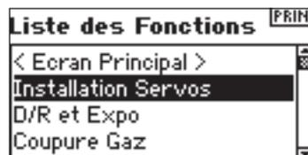
Faites tourner le barillet jusqu'à surligner Servo Setup (Réglage Servo) et appuyez sur le barillet pour passer aux écrans Servo Setup. L'écran Travel Adjust (Réglage de course) apparaît automatiquement. Utilisez le barillet pour passer à l'option Reverse (Inverser).
