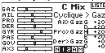
Pour tester le fonctionnement correct du mixage de cyclique et cela dans la bonne direction, mettez l'interrupteur de mode de vol dans l'une des positions actives. Faites bouger la voie de cyclique ou de direction programmée en notant la position de la manette des gaz. La position des gaz devrait augmenter si elle diminue, il faudra opter pour les inverses (positives au lieu de négatives).
