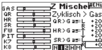
Überprüfen Sie die richtige Mischfunktion und die richtige Richtung, in dem Sie den Flugzustandsschalter in aktive Position schalten. Bewegen Sie die Zyklische Funktion oder das Heck und beobachten Sie das Gasservo. Das Gas sollte erhöht werden. Wird es reduziert, müssen Sie das Vorzeichen des Wertes ändern.
