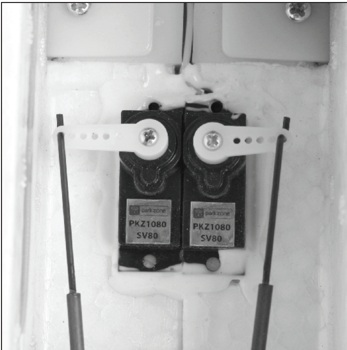
Werkseinstellungen für die Servoarme des Seiten und Höhenruderservos
