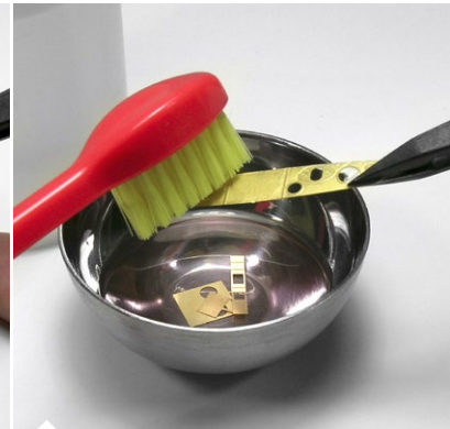
With a brush clean the parts, the acetone will remove all possible traces of grease and dirt. Con un cepillo, limpia las piezas, la acetona eliminará todos los rastros posibles de grasa y suciedad.
