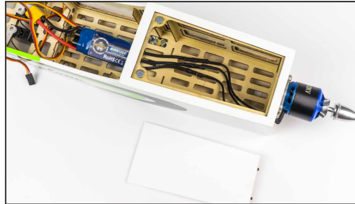
打开仓身盖，安装电调，并连接马达线。 Open the cabin cover, install ESC, and connect motor wire.
