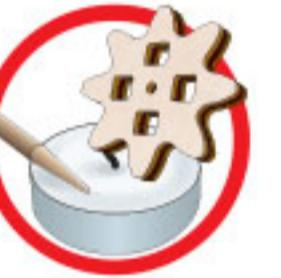
ENG Wax the part with a regular candle (rub with a candle). UKR Змастіть деталь звичайною свічкою (потрій об свічку). FRA Lubrifiez la pièce avec une bougie ordinaire (frottez contre la bougie). DEU Reiben Sie das Teil mit einer einfachen Kerze etwas ein. SPA Engrase la pieza con una vela común (frote con una vela). ITA Incerare il componente (Sfregare con la cera). JPN された部分に潤滑剤として口ウソクを塗ってください。 CHI 用普通蜡烛涂抹润滑部件.
